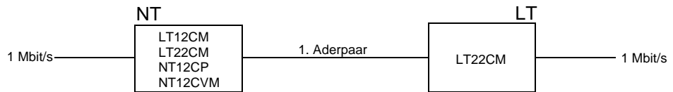
Bild 3.2 Fractional Installation bei 2-Mbit/s-Verbindungen
